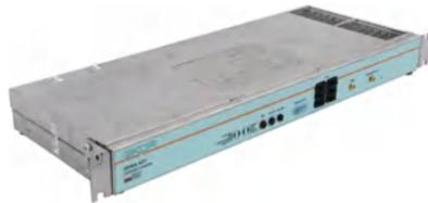
Сервер телемеханики EKRA A01 может использоваться в составе АСУТП, ССПИ на подстанциях всех классов напряжения. Он предназначен для сбора информации от устройств уровня присоединения и последующей ее ретрансляции в центры управления сетями и диспетчерские пункты (ЦУС, РДУ) независимо от средств стационарного уровня объекта автоматизации. Также он осуществляет информационное взаимодействие со смежными автоматизированными системами.
