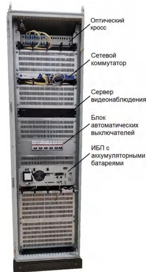
Шкаф серверов видеонаблюдения типа ШНЭ 2083.001 позволяет организовать автоматизированный сбор и сохранение больших объемов данных с управляемых IP-видеокамер, а также обеспечить коллективный удаленный доступ к «онлайн картинке» и архиву видеoinформации. Шкаф рассчитан на непрерывную круглосуточную эксплуатацию в закрытых отапливаемых помещениях. ИБП в его составе способен поддерживать работоспособность оборудования при кратковременных перебоях в сети электропитания.
